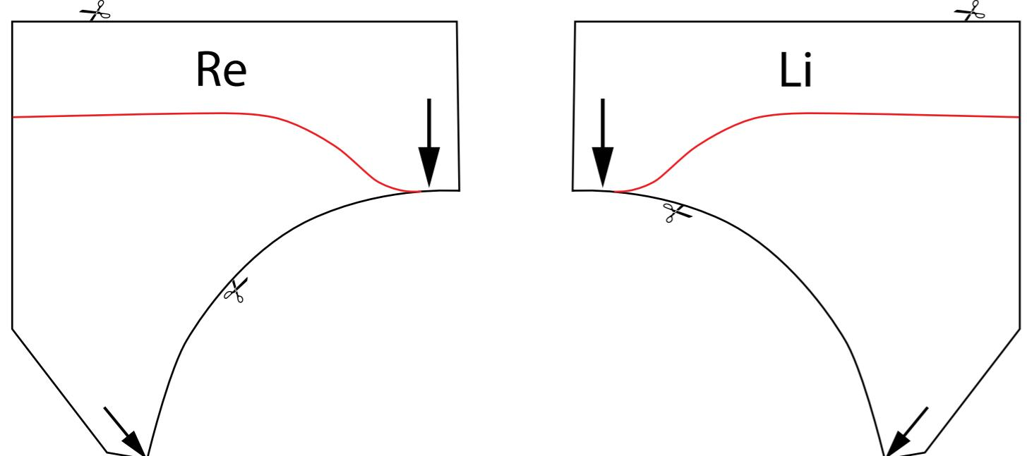
Einbau bei rechter Tür / Jig for right door / gabarit de coupe pour la porte à droite / sjabloon voor de deur rechts
