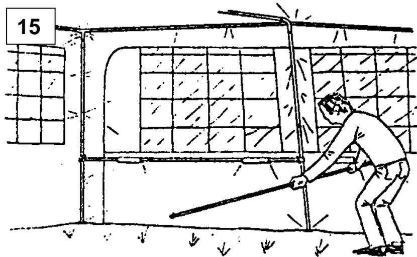
12. Alle Standbeine ausrichten, damit der Erdstreifen in gleicher Höhe auf dem Boden liegt.
