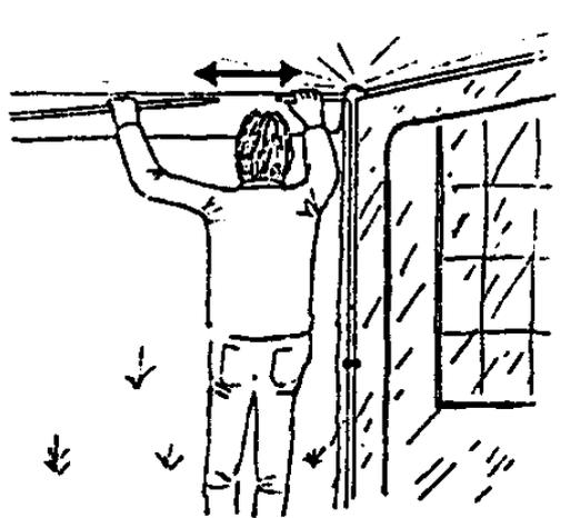
8. Vordachstützen in linken, rechten und mittleren Winkel einschieben und feststellen. Vordachspannstäbe in Hohlraum des Vordaches einführen, mit Vordachstützen verbinden und etwas ausspannen (Abb.12a).
