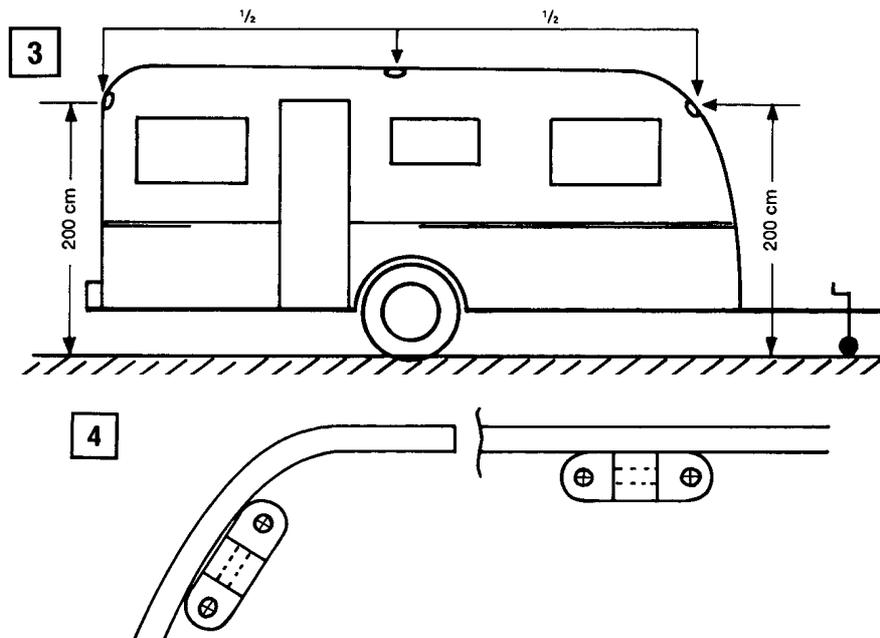
Wohnwagen zur genauen Maßermittlung auf ebenem Gelände in Waage stellen. Die Montage der Dornhalter entfällt, wenn das Zelt mit dem Easy-Clip-System ausgestattet ist. Die Easy-Clip-Halter werden in den am Zelt angenähten Easy-Clip-Keder eingezogen und anschließend mit Hilfe der Dachstangen an den Wohnwagen angedrückt (s. Abb. 3 und 5).
