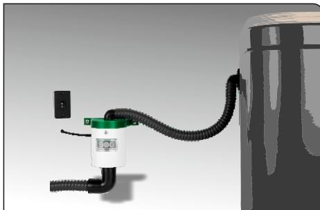
La ventilación aspira los olores no deseados y los elimina a través de un filtro especial de alto rendimiento.
