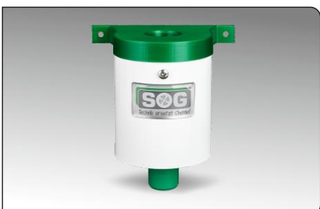
Hierfür den Schlauch unten abziehen und die Schraube lösen. Die Filterpatrone durch leichtes Drehen nach unten ziehen. Filtereinheit wird komplett ersetzt und wieder mit der Schraube befestigt.
