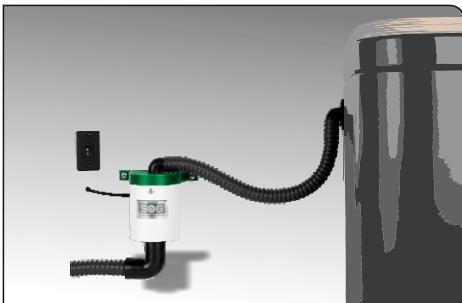
Ventilationen suger in oönskade lukter och tar bort dem genom ett speciellt högpresterande filter.
