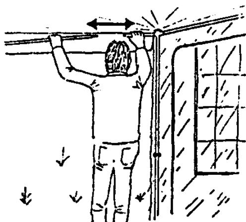
8. Zasuňte podpěru stříšky do levého, pravého a středového úhlu a utáhněte ji. Vložte napínací tyče vrchlíku do lemu vrchlíku, připojte je k podpěře vrchlíku a mírně napněte (Obr. 12a)
