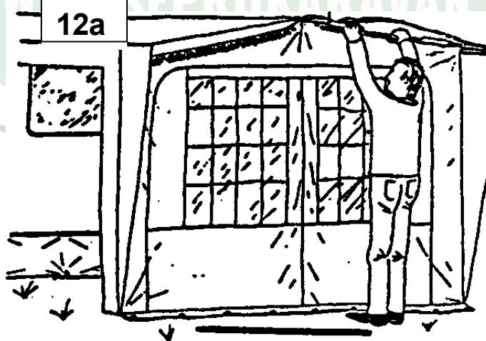
**Upozornění:** U střechy s perforovaným svislým švem se při zatažení tyče stříšky vynechá otvor, aby byl umožněn přístup ke středovému šroubu trubkové svorky (obr. 12b).
