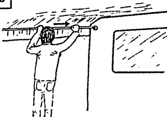
7. Spojte levou a pravou boční konzolu se středovou konzolou, zasuňte je do bočních čelních výřezů a poté postupujte podle bodu 5 (obr. 11).
