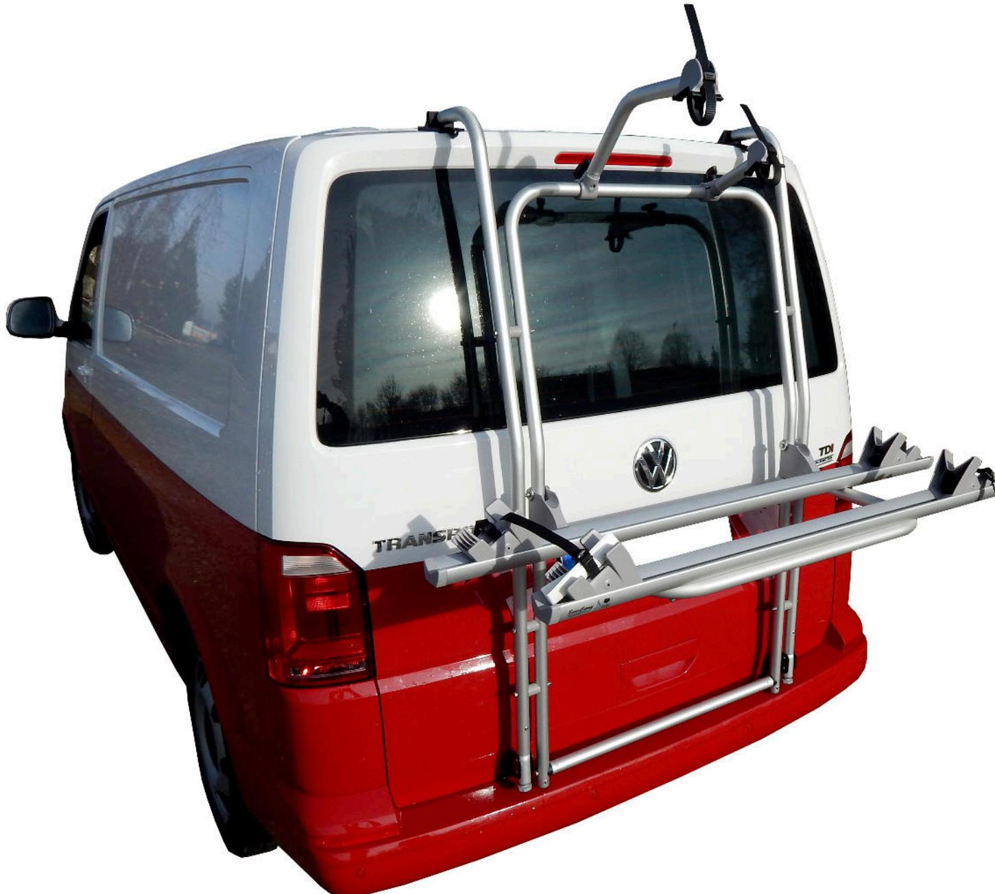
Der EuroCarry VW T6 Träger ist durch seinen Doppelrohrrahmen sehr stabil und verwindungssteif. Träger für den Transport von bis zu 2 Fahrrädern mit einem maximalen Gesamtgewicht von 40 Kilogramm. Heckklappe kann im montierten Zustand (unbeladen) geöffnet werden. Es wird empfohlen, vor der Montage des EuroCarry VW T6 Trägers, die Seriengasdruckfedern der Heckklappe gegen Gasdruckfedern mit 1250 N auszuwechseln. (VW-Bestell-Nr.: 7H7 827 550)
