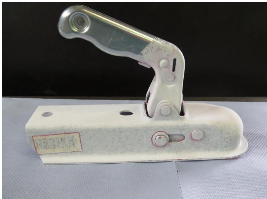
**Abb. A1-6** Übersicht Rissprüfung rechte Prüfmusterseite
