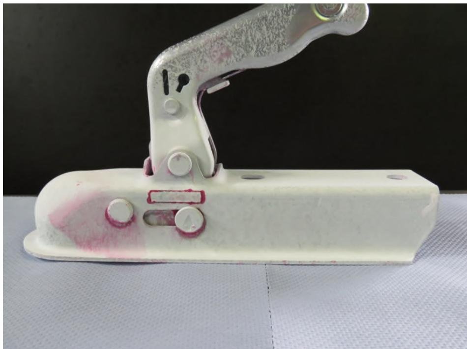
**Abb. A1-5** Übersicht Rissprüfung linke Prüfmusterseite
